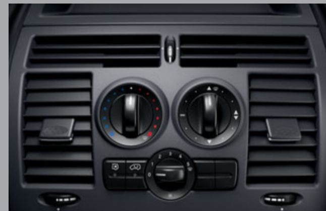
Snažan uređaj za grijanje i prozračivanje. Pregledno i lako dostupno: regulatori 5-stupanjskog uređaja za grijanje i prozračivanje.
