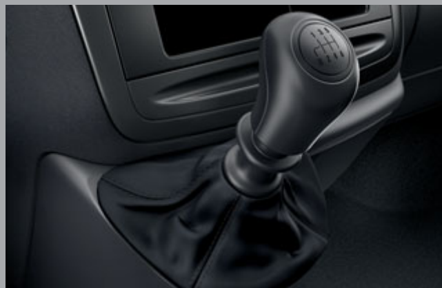
Praktično prebacivanje stupnjeva prijenosa u obliku joysticka. Mjenjač s novodizajniranim ergonomskim okruglim završetkom presvučen umjetnom kožom.
